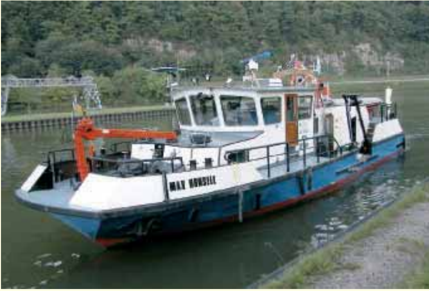
Die Max Honsel, das Messschiff der LUBW kommt bei der Überwachung der Wasserstraße Neckar zum Einsatz. Sie ist sowohl für die Untersuchung biologischer Qualitätskomponenten wie auch für physikalisch-chemische Untersuchungen ausgerüstet.
